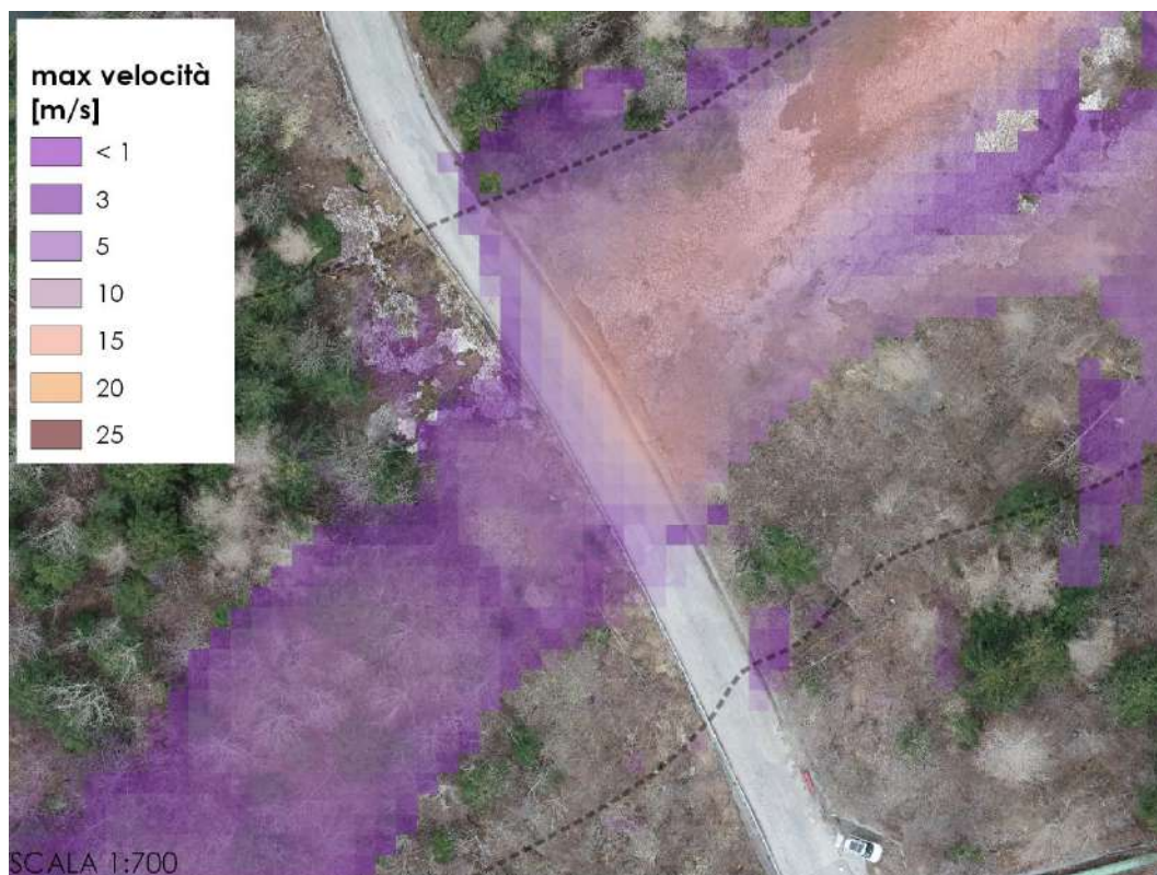
Figura 8.3: Massime velocità nei pressi della strada per la valanga con Tr 100 allo stato di fatto.
